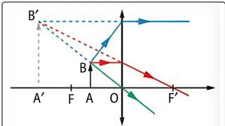
Image virtuelle, obtenue avec un objet placé entre le foyer objet F et le centre optique O :
